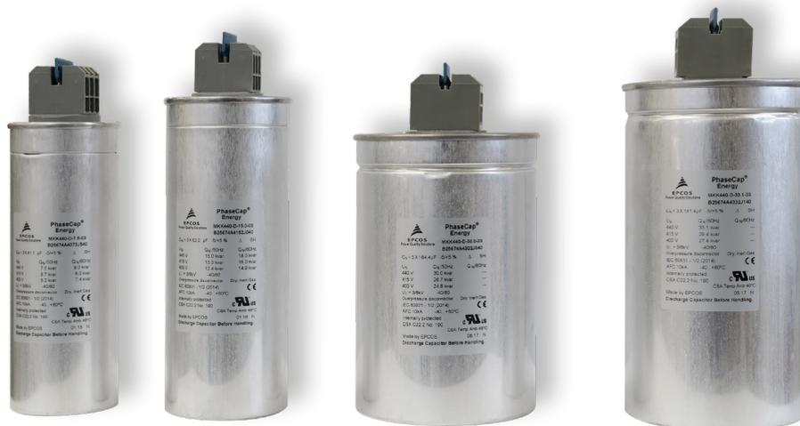
I condensatori **MKK ENERGY** sono del tipo autorigenerabile a secco in contenitore di alluminio; il dielettrico è costituito da Film di Polipropilene metallizzato a basse perdite e gas inerte. Grazie ad una nuova tecnologia avanzata si è ottenuta una elevata affidabilità: all'interno del cilindro vengono sovrapposte tre capacità isolate elettricamente e collegate a triangolo o a stella. La costruzione dei condensatori e le prove sono effettuate secondo le EN 60831-1/2 (DIN VDE 0560/46)
